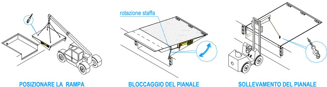
Prima di iniziare le operazioni di posa della rampa verificare che il profilo sia stato giustamente gettato avvalendosi del disegno \_\_\_\_\_ allegato, e dopo procedere come segue:
