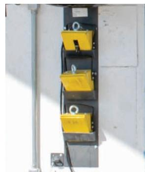
A cunha metálica garante a imobilização do veículo durante as operações de carga e descarga, sendo inserida entre a roda do caminhão. Quando integrante do SISTEMA DE SEGURANÇA VISUAL E SONORO, possui um sensor automatizado em sua extremidade para interligação com os demais itens.
